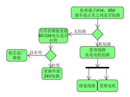
进一步确认机芯是否损坏:用万用表测量报错端口的阻值看是否短路,短路说明机芯的刹车输出损坏。
